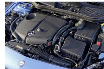
**In der Motorabdeckung der neuen A-Klasse (Benzinmotor M270) kommt bei Mercedes-Benz zum ersten Mal in einer Großserie ein Biopolymer zum Einsatz. .**
